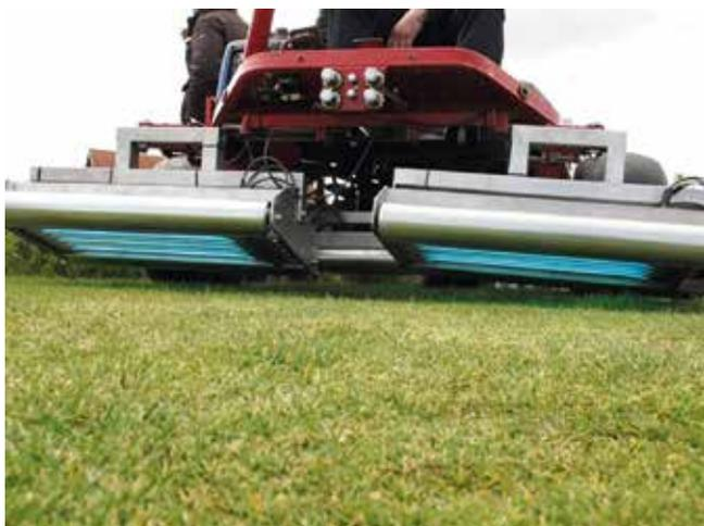
**Abb. 6: Bügeleinheiten mit integrierten UVC-Lampen (Anbieter: UVC Turf Care)**
