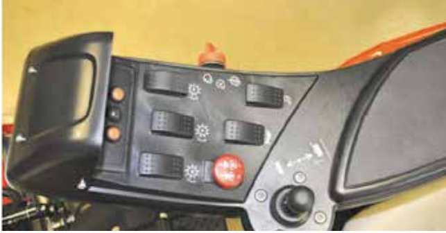
Alle Maschinenfunktionen werden von hier gesteuert, einschließlich PIN Code, Geschwindigkeit und FOC
