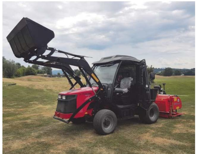
und auch die optimale Arbeitsgeschwindigkeit wird durch den hydrostatischen Fahrtrieb sichergestellt. Die Technologie-Umkehr sorgt für weniger Flächenbelastung und Nacharbeit.“
