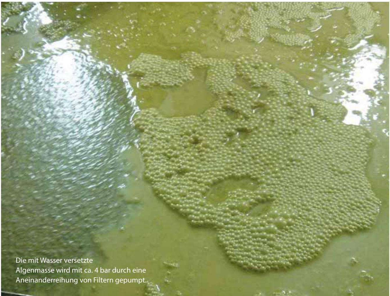
Die mit Wasser versetzte Algenmasse wird mit ca. 4 bar durch eine Aneinanderreihung von Filtern gepumpt.
