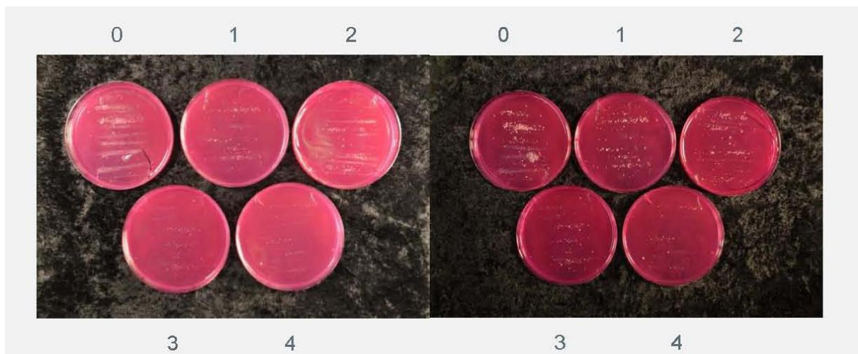
Abb. 2: Abdrücke von UV-C exponierten Grashalmen auf Agar. Linkes Bild nach 16h Inkubation, rechtes Bild nach 24h. (0-Kontrolle; 1x, 2x, 3x, 4x unter dem UVC-Modul) (Quelle: AIT Dr. M. Gorfer in Kooperation mit UVC TurfCare, Klaus D. Schmitt Course Support e.K.)
