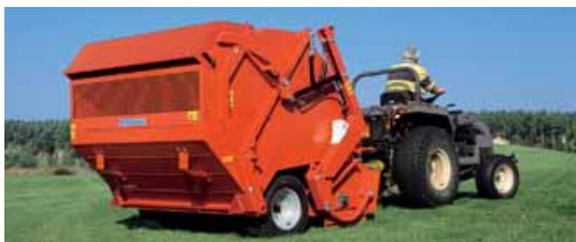
te Kehrkopf passt sich Bodenunebenheiten an. Mit werkzeuglosem Wechsel der Flügel-, Kehr-, Schlegel- und Vertikutiermesser.
