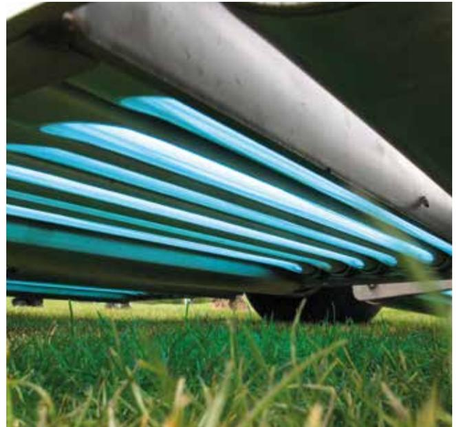
**Hier zu sehen: UVC TurfCare Lichtmodule von unten, die bei einer Umgebungstemperaturen von +5 Grad bis +30 Grad keinen Leistungsverlust haben, wie die übrigen UVC-Lampen, die weit aus höhere Temperaturen für optimale Wirksamkeit benötigen)**
