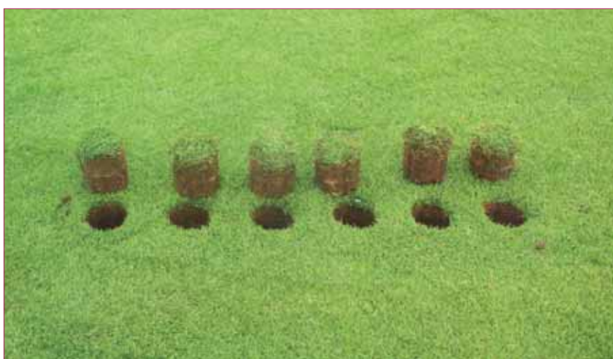
Rasenstücke wurden von einem Testfeld entnommen und in einer Klimakammer bei drei unterschiedlichen Temperaturen gelagert, um die Auswirkungen von Temperatur auf den Abbau von Fungiziden zu untersuchen.
