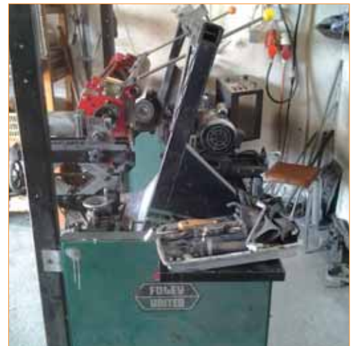
Spindelschleifmaschine – Marke Foley Utd. USA, Baujahr: 1990, Importeur in EU ist unbekannt, CE-Kennzeichen nicht vorhanden, Fehlende Sicherheitsvorkehrung: Abdeckung der Maschine
