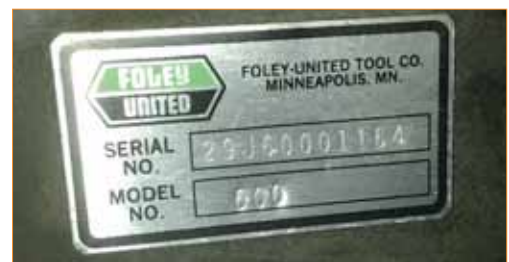
Typenblatt zur Spindelschleifmaschine Foley United / USA CE-Kennzeichen ist nicht auf dem Typenblatt vorhanden
