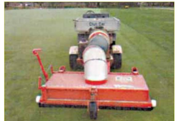
2013 and der Lewis-Brown Farm in Corvallis, Oregon: Die Behandlungen zum Tauentfernen waren wie folgt: Täglicher Einsatz einer Taurute (oben), Rollen mit einem Tru-Turf Roller (links) und Abblasen mit einer Buffalo Turbine und Sanddevil-Anbau (rechts).
