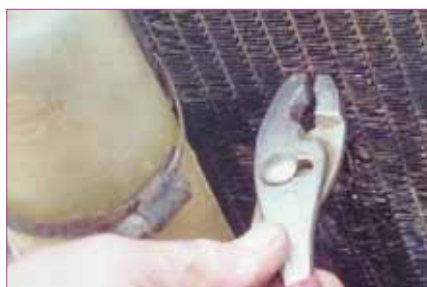
Mit Hilfe einer Zange kann man kleinere Löcher im Kühler reparieren. Wird der Flüssigkeitsverlust nicht weniger so hat man einen Kühler mit dünnen Innenwänden, die dem Druck nicht mehr standhalten.
