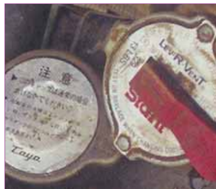
Neue Kühlerdeckel haben einen Sicherheitshebel durch den Druck abgelassen werden kann. So muss der Deckel nicht geöffnet werden.
