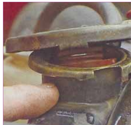
Kühler haben eine Vertiefung (siehe Fingerspitzen) in der der Deckel einrastet wenn dieser nur gelockert wird. So kann Druck aus dem System entweichen. Um den Deckel ganz zu entfernen nach unten drücken und zugleich drehen.
