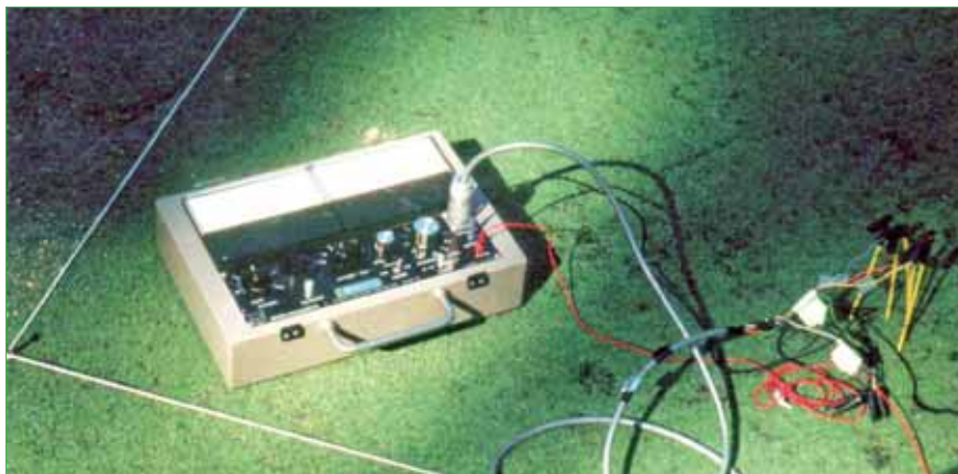
Messen von Sauerstoffdiffusion mit Platinelektroden in einem Putting Grün in Nord-Michigan mit Black Layer.
