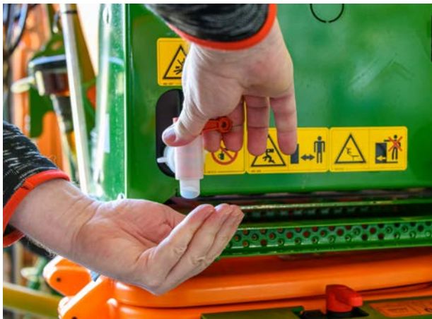
Abb. 13: In Feldspritze integrierter Frischwasserbehälter mit Auslasshahn
