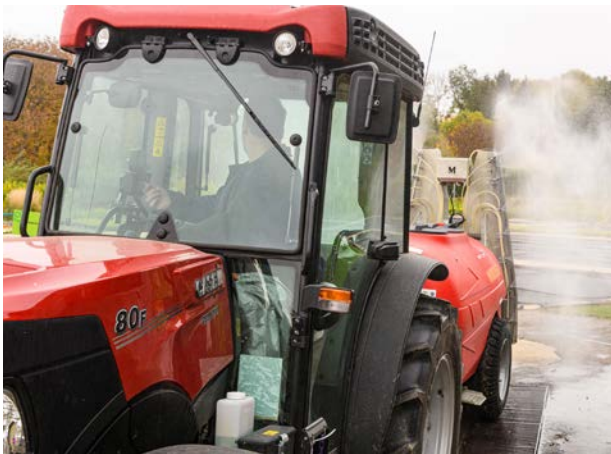
Abb. 18: Der Spülvorgang kann bei modernen Traktoren von innen bei geschlossener Kabine gesteuert werden.
